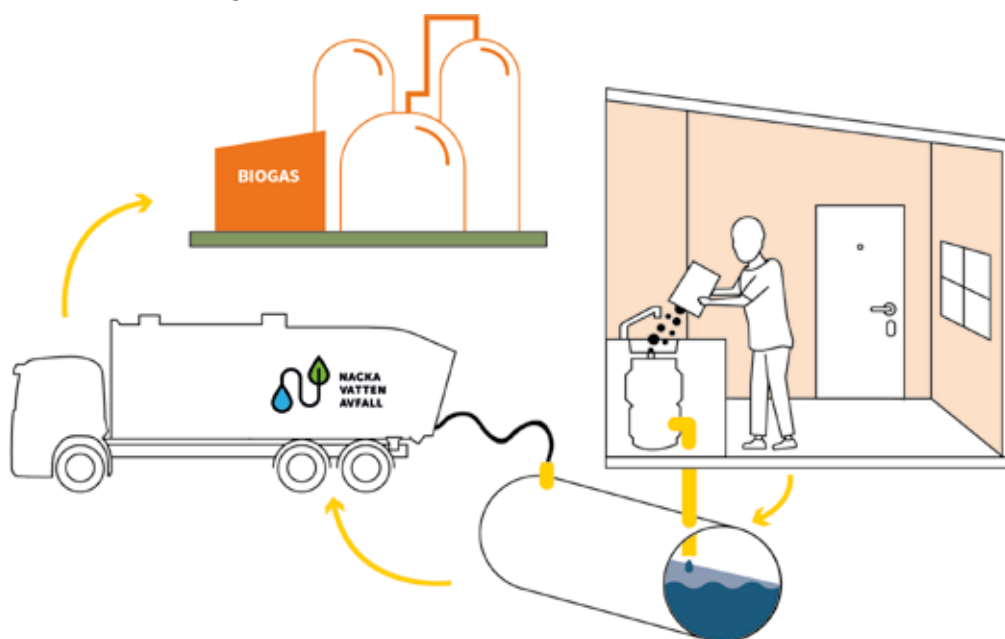
Matavfallskvarn till tank.
