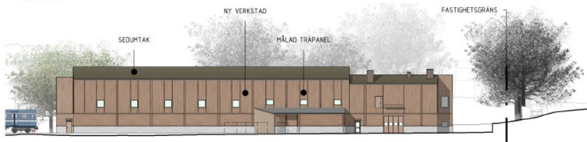
FASAD MOT SÖDER SKALA 1:500
