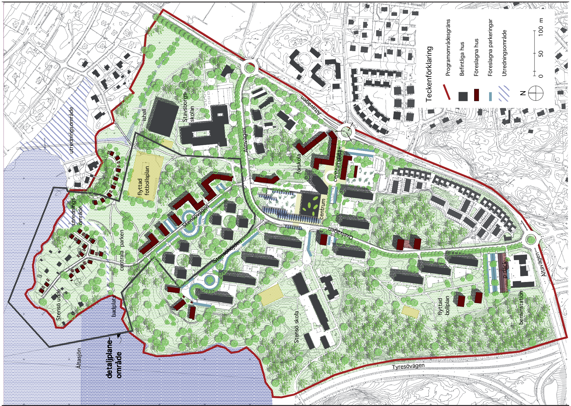
Planbild över hela programområdet, från "Älta C och dess närområde - Program för ny bostadsbebyggelse och centrum - september 2004". Skala 1:5000. Aktuellt detalplaneområde inlagt som grå linje.
