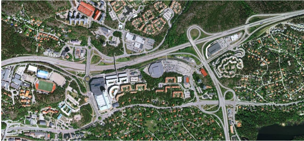
Figur 2. Satellitfoto över området i dagsläget, med trafikplatserna Nacka, Skvaltán och Skogalund. Vid cykeltunneln i bildens västra utkant dras Kvarnholmsförbindelsen planskilt under Värmdöleden (foto från eniro.se).
