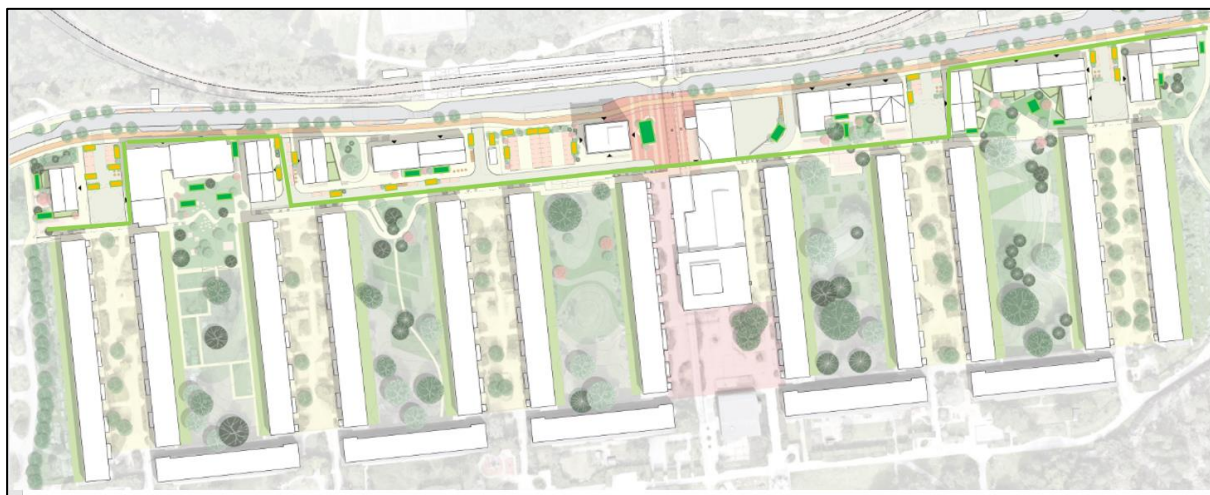
Figur 16. Skiss över var dagvattenlösningar i form av regnbädd (grön) och växtbädd (gul) kan placeras. Dagvattenledningen planeras längs den gröna linjen.
