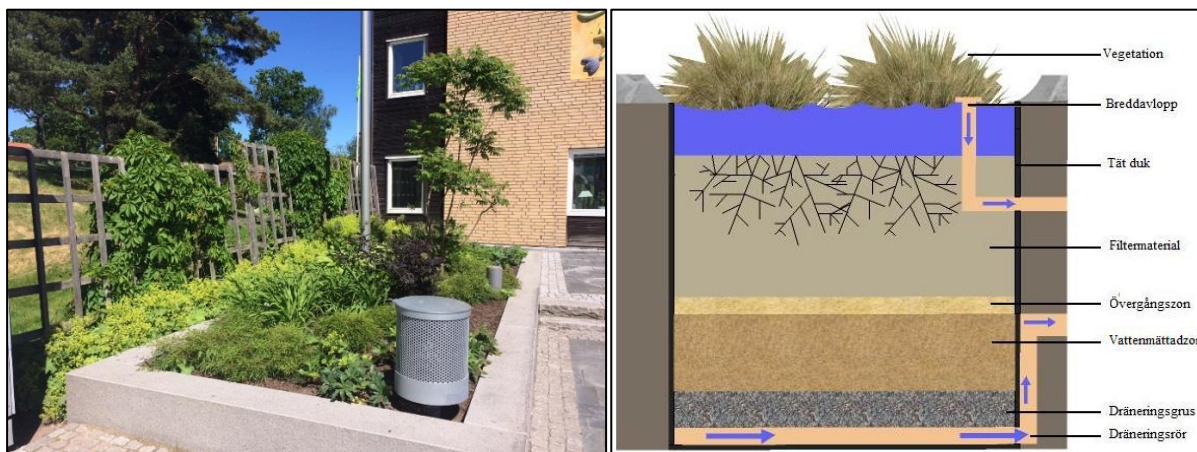
Figur 15. Exempelbild på upphöjd regnbädd samt lösning i genomskärning (Anders Svendrup).
