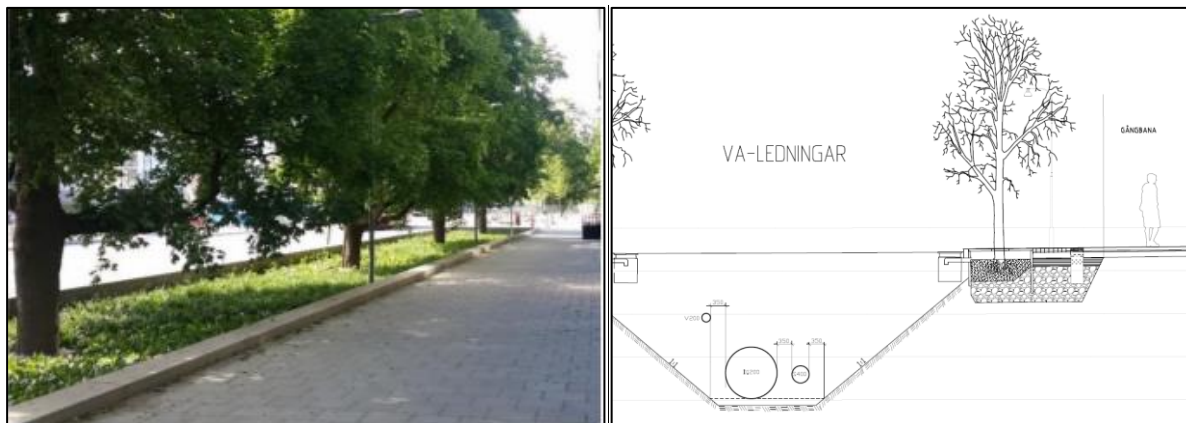
Figur 14. Exempelbild på trädplantering (Nacka kommun, 2018) samt lösning i genomskärning (NOVAMARK AB).
