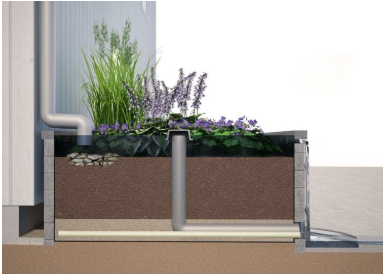
Figur 13 Växtbädd med tät duk för takvatten (Fridell, K och Klasson, K, Tengbomgruppen AB, 2014)
