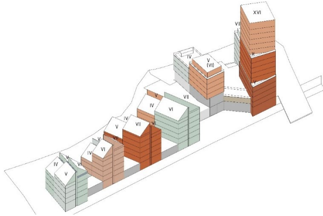
Bebyggelseförslaget sett från Värmdövägen. Principskiss som visar det västra kvarterets trappning av höjder mot norr, sammanbindande sockel, variation i kulör samt takutformning. Det angivna våningstalet inkluderar vind. Bild: Semrén & Månsson
