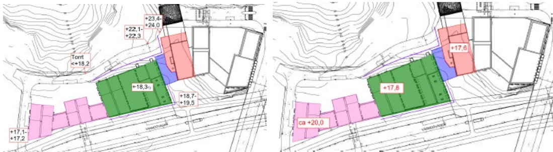
Bild till vänster visar befintliga grundvattennivåer, bild till höger visar ungefärliga nivåer för schaktbotten för byggnad. Bilder: Iterio, 2022.
