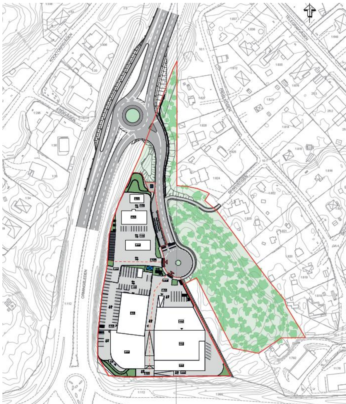
Övergripande illustrationsplan för planområdet som visar den nya väganslutningen från Ormingeleden och möjlig utformning av ny bebyggelse och kvartersmark. Plangräns i röd linje. Bild: XYZDP
