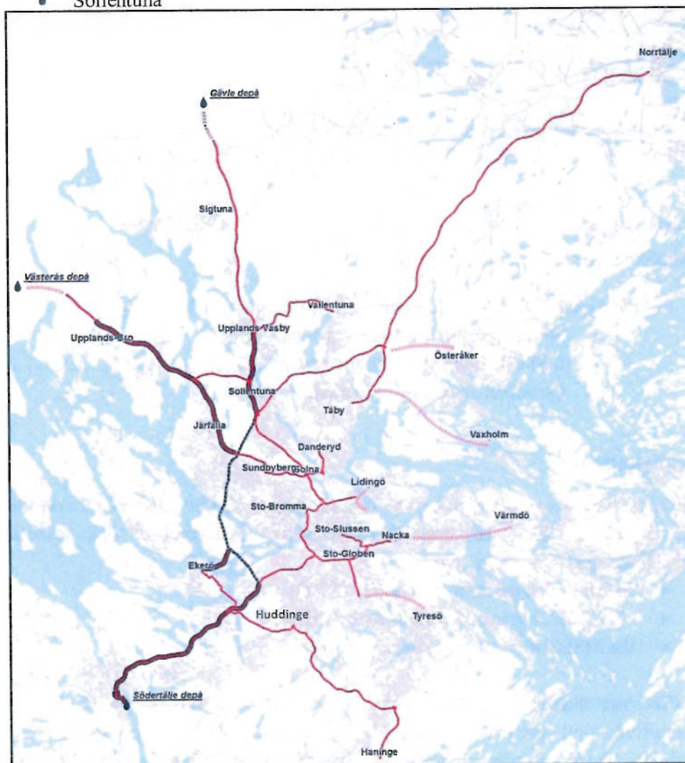
Figur 13. Karta över transportvägar scenario C5 utbyggd Södertälje 50 %, omfördelning av volymer 50 %. Streckad väg avser Förbifarten och röd/svart markerade vägar avser transportrelationer som förändras från Södertälje depå när Förbifarten byggs.
