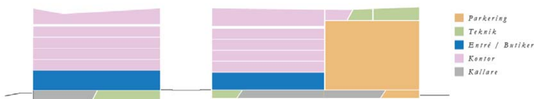
Programsektion över byggnadsvolymerna sett från Uddvägen
