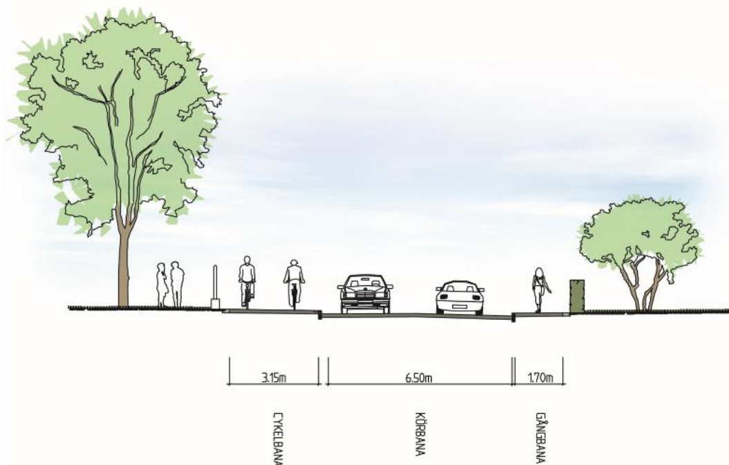
Bild 33. Separerad cykel- och gångbana i Sickla, km 8/040-8/600.
