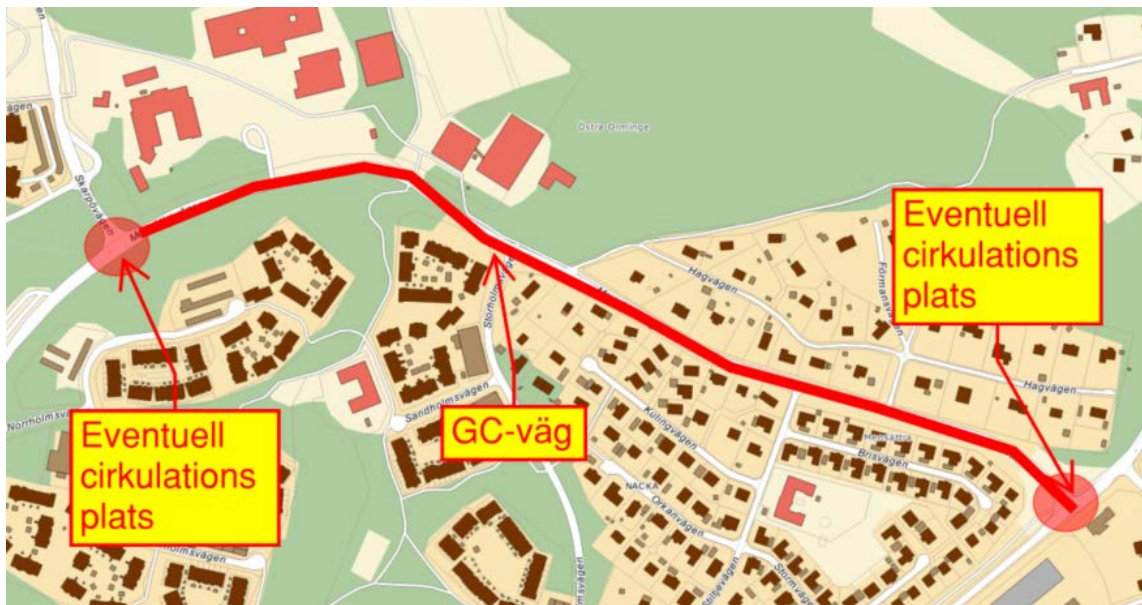
Bild 15. Översiktlig dragning av ny gång- och cykelväg längs norra delen av Mensättravägen samt eventuella cirkulationsplatser.
