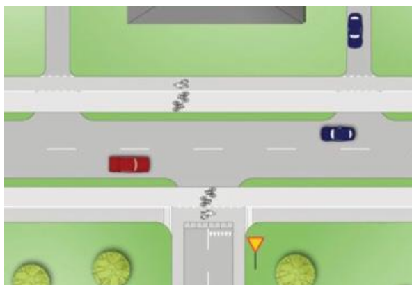
Bild 30. Princip för korsningar med anslutande sidovägar (Källa: regional cykelplan för Stockholms län).
