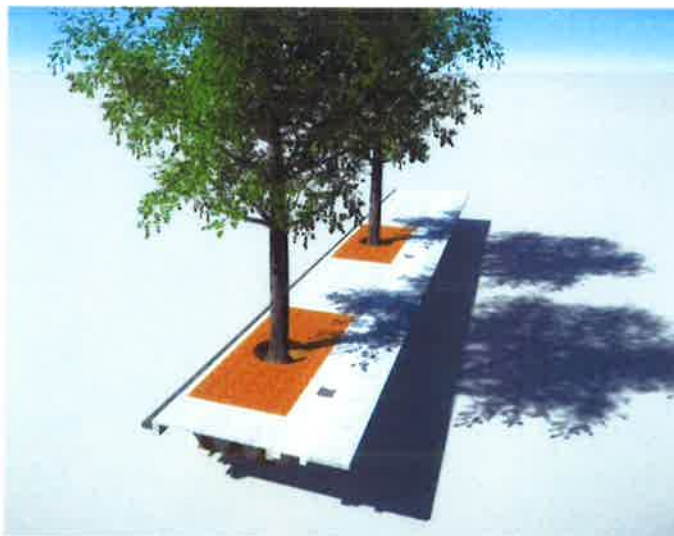
Figur 8. Täckt regnbädd i gata. Dagvatten från GC-bana leds in via luftningsbrunn med sandfång och perforerad sida till luftigt bärlager (t v i övre bilden) ner i skelettjorden som anläggs intill regnbädden. Dagvatten från väg leds via inloppsbrunn med sandfång (gul) till nedsänkt regnbädd som är täckt med markgaller eller plåt. Inloppsröret mynnar några centimeter över växtbädd. Överskottsvatten avleds via dränering och bräddbrunn.
