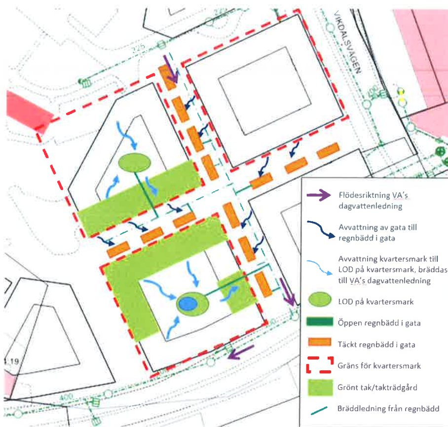
Figur 3. Ex på dagvattensystemets principuppbyggnad i Nacka Stad.
