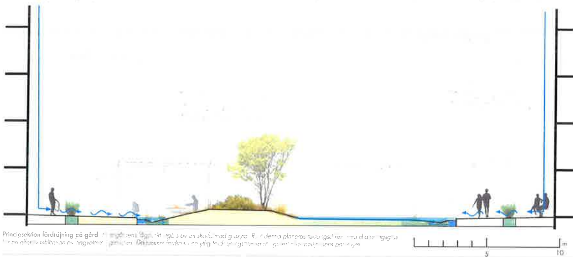
Principsektion fördröjning i förgårdsmark. Dagvatten från huslök och gator/bor i kvarteret som leds till vattenlös sadelök eller 100 m 2 öfver, där breddas i kommunalt dagvatten system.
