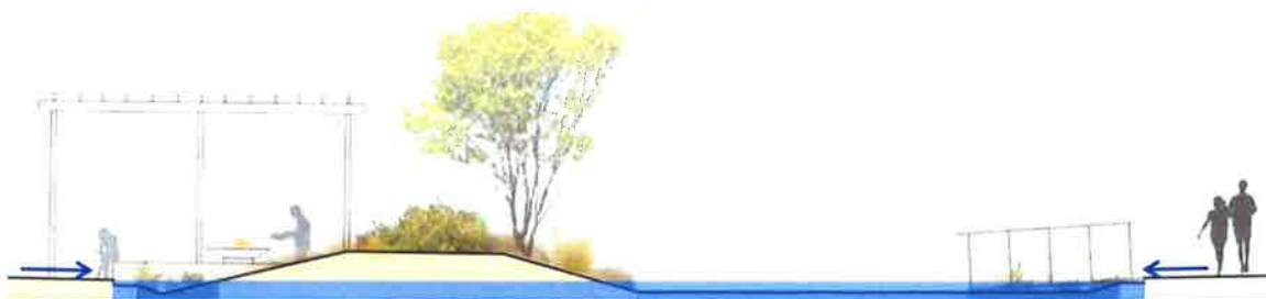
Figur 3. Principutformning dagvattenhantering på innergård för fördröjning och rening av dagvatten. Bild från Topia Landskapsarkitekter 2018-01-25, erhållen av Topia Landskapsarkitekter, korrigerad av Structor Uppsala AB 2018-01-29.
