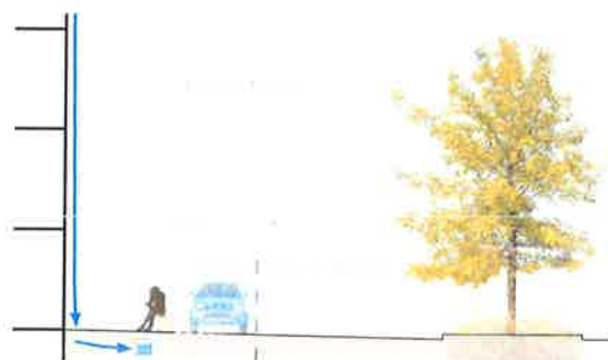
Principsektion fördröjning i förgårdsmark. Dagvatten från huslök och gator/bor i kvarteret som leds till vattenlös sadelök eller 100 m 2 öfver, där breddas i kommunalt dagvatten system.
