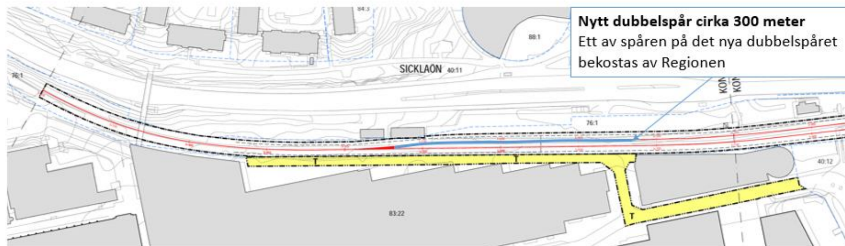
Figur 4. Schematisk skiss i plan på vad som ska bekostas av Regionen på sträckan där enkelspår blir dubbelspår cirka 300 meter markerat med blått.
