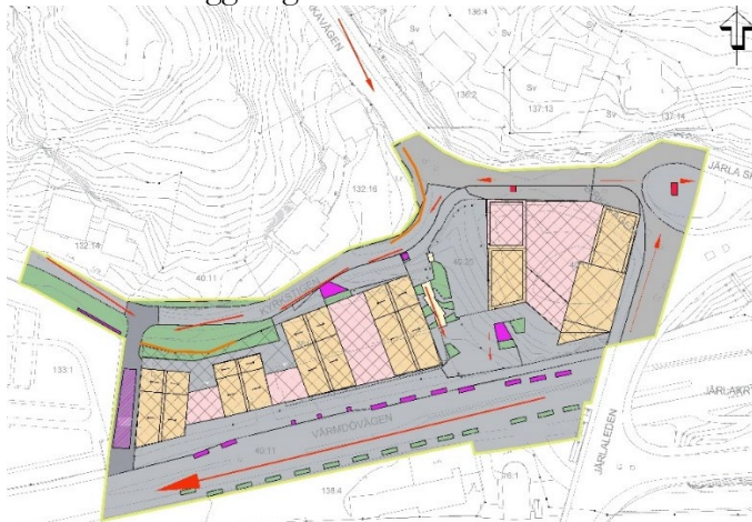
Bilden visar hur skyfall ska ledas från planområdet. Röda pilar visar skyfallets riktning. Bild: Geosigma, 2022
