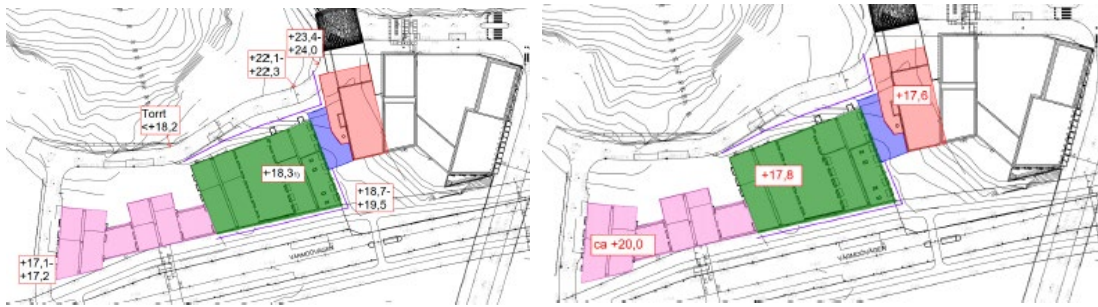
Bild till vänster visar befintliga grundvattennivåer, bild till höger visar ungefärliga nivåer för schaktbotten för byggnad. Bilder: Iterio, 2022.
