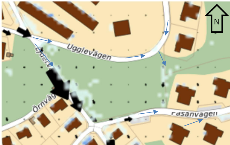
Figur 8. Förstorad vy av utredningsområdet hämtat från Nacka Stads Skyfallsanalys för ett 100-års regn med klimatfaktor 1,2. Blå och svarta pilar visar ytliga flödesvägar baserade på en topografisk analys.
