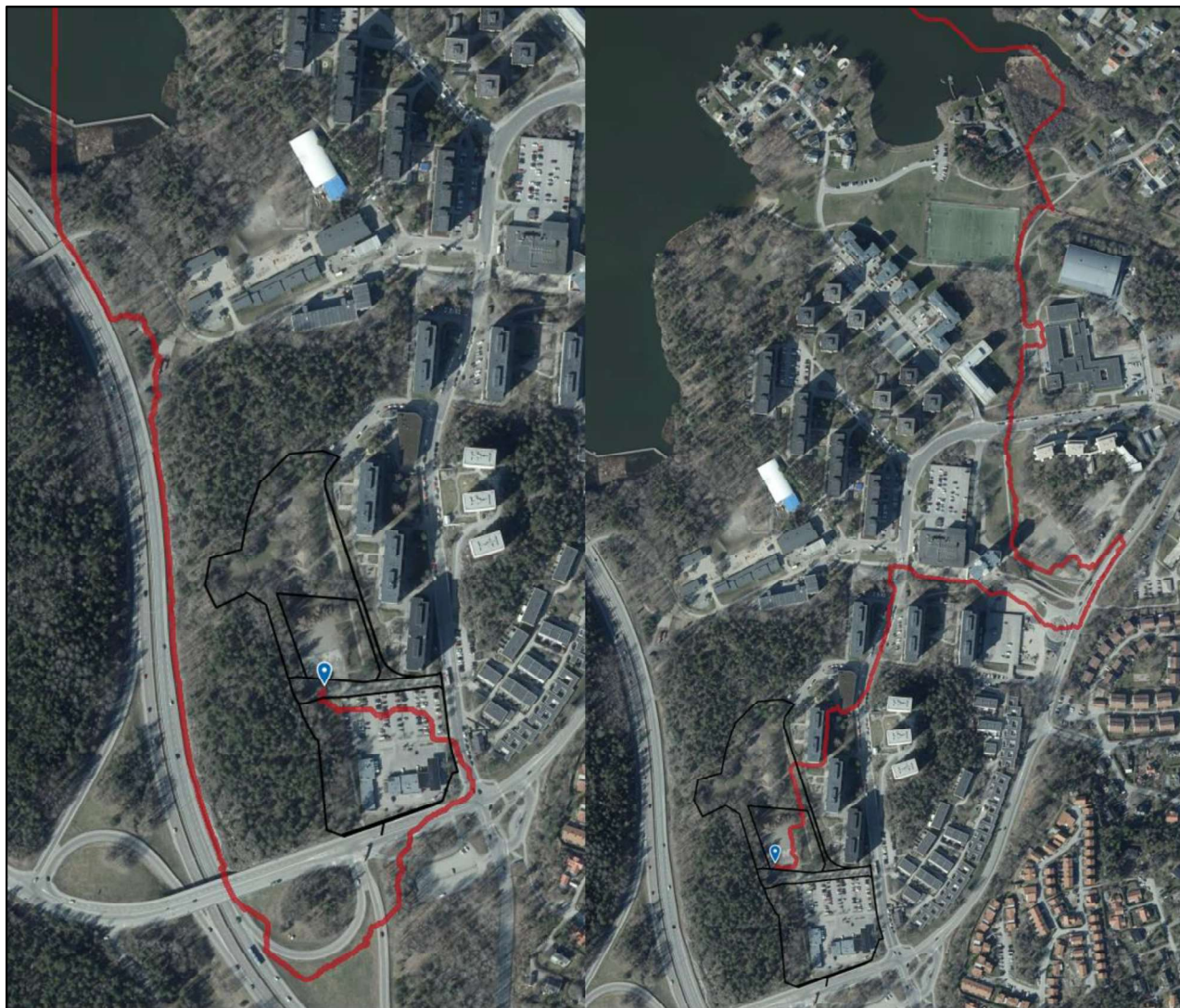
Figur 4-2. Ytliga avrinningsvägar (röda linjer) baserat på sammansatt höjdmodell från utredningsområdet till recipienten Ältasjön i norr. Bild: Flygfoto från Scalgo Live (Scalgo, u.d.)
