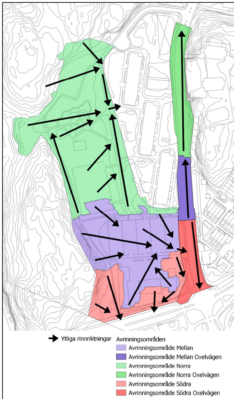
Figur 4-3. Befintliga avrinningsområden inom planområdet baserade på sammansatt höjdmodell, med pilar som visar yttlig rinnriktning.
