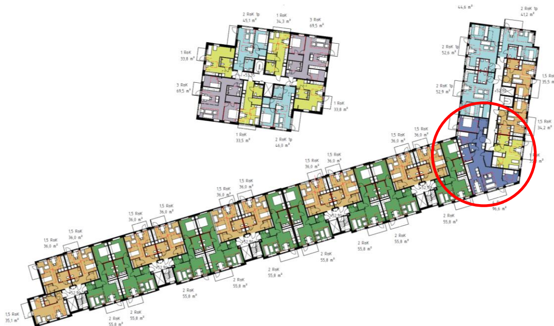
Figur 43: Typplan som redovisar det södra kvarteret som i söder vetter mot Ältavägen och i norr mot Oxelvägen. Inringad del har ekvivalent ljudnivå över 60 dBA och därför behöver en stor lägenhet placeras med hälften av boningsrummen mot tyst sida. (Lindberg Stenberg Arkitekter 2025)
