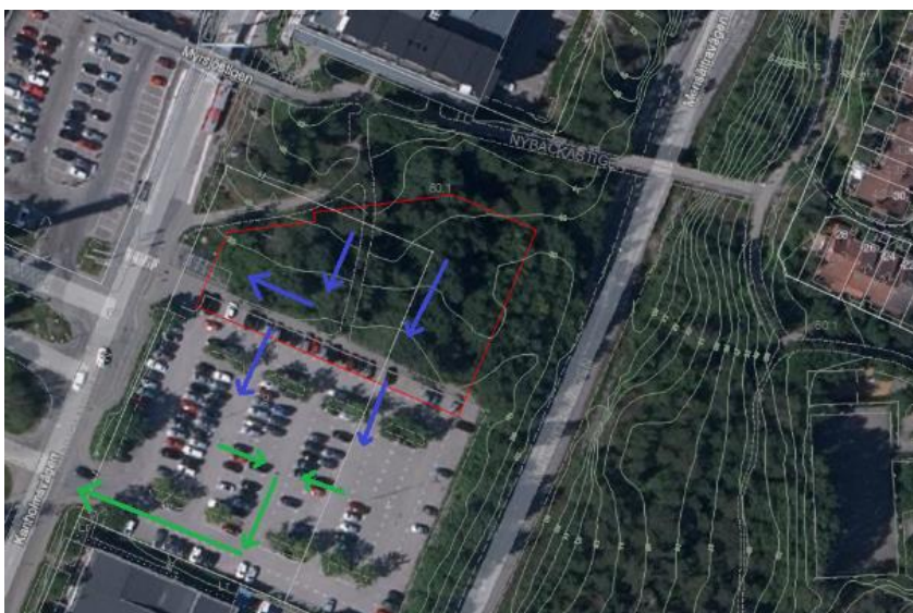
Figur 2. Ortofoto och höjdkurvor med uppdragsområdet inom röd linje. Blå flödespilar illustrerar ytaavrinningens riktning och de gröna pilarna flödesriktningen i dagvattenledningarna.
