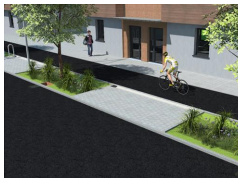
1b. Öppen regnbädd med träd och markvegetation
