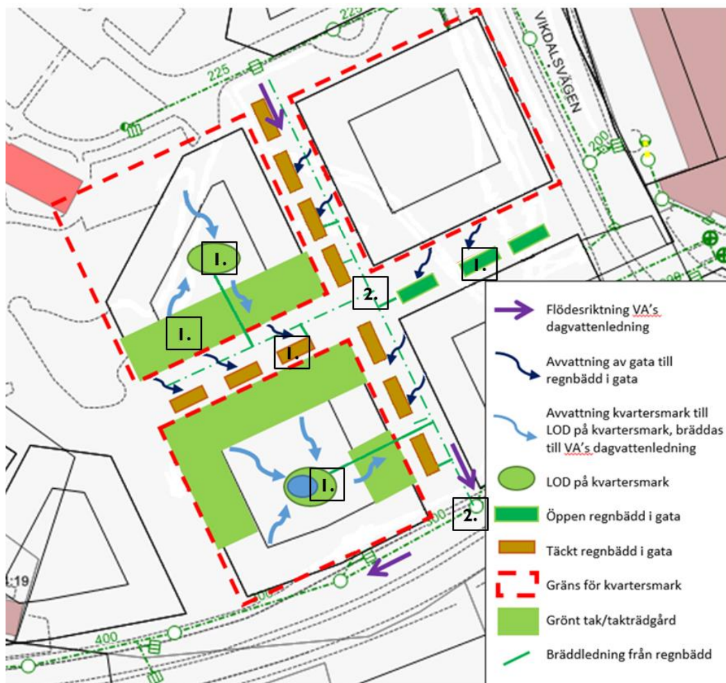
Figur 3. Exempel på dagvattensystemets principuppbyggnad, siffrorna hänvisar till texten i avsnittet ovanför.
