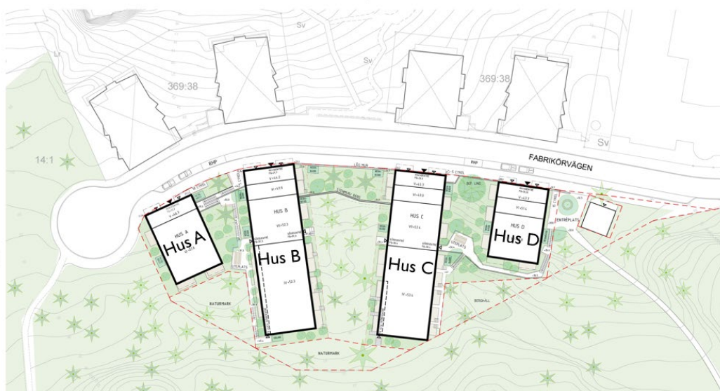
Figur 16 Övergripande illustrationsplan för planområdet, föreslagna nya byggnader i vitt med svart kontur. Brf Gustafshög 1 på norra sidan av Fabrikörvägen. Observera att vändplanens utformning inte motsvarar detaljplanens avgränsning. Fabrikörvägens och vändplanens utformning kommer att studeras vidare under det fortsatta planarbetet. Bild: White arkitekter, 231026.
