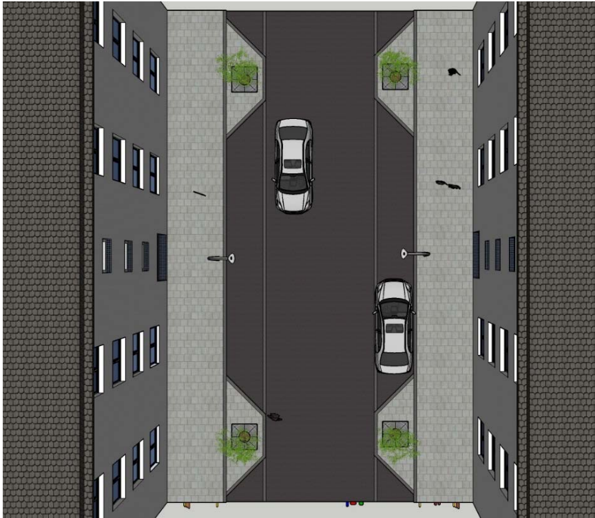
Bild: Lokalgata exempel 2 uppbyggd med moduler, total bredd på gatusektionen är 15,5 meter. Parkeringsfickor med träd på båda sidor av gatan.
