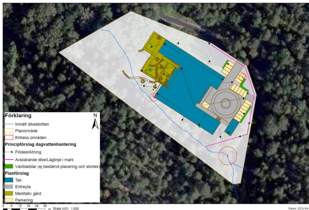
Figur 14 Skiss av föreslaget dagvattensystem enligt exploateringsförslag.
