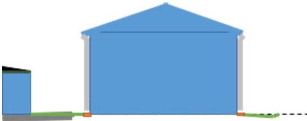
Figur 17 - Generell dagvattenlösning för tomter inom Amperen, där allt vatten fördröjs inom fastigheten med fördröjningslager (orange), permeabel parkeringsyta (grå) samt svackdiken vid tomtragransen (grön). Alla ytor leder mot svackdiken vid tomtragransen (Geoveta, 2020).
