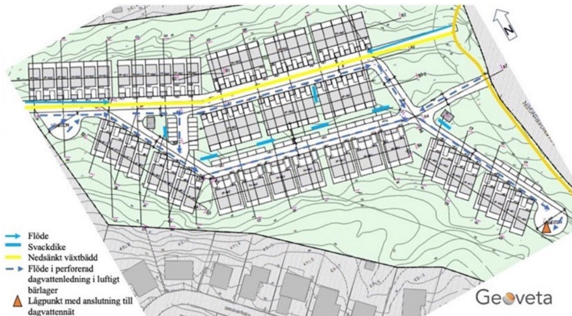
Figur 18 - Planerad bebyggelse med dagvattenlösningar för kvartersmark och väg, gång- och cykelbana. Dagvattenhantering för respektive tomt hanteras inom respektive tomt (Geoveta, 2020).
