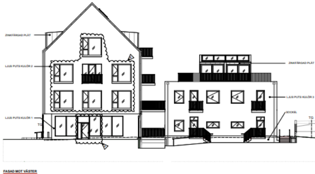
Bygglöshandling som visar byggnadernas fasader mot väster.
