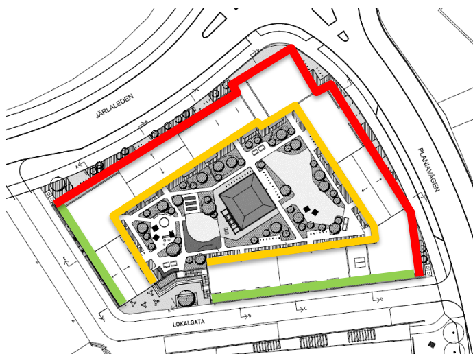
Figur 22. Vid gröna fasader tillåts balkonger kraga ut 1.4 meter med en lägsta fri höjd på 4.0 meter. Vid röda fasader tillåts inte utkragande balkonger. In mot bostadsgården tillåts balkonger kraga ut 2.0 meter med en lägsta fri höjd på 3.0 meter.
