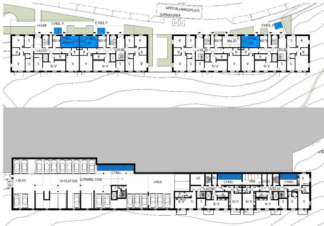
Figur. Planerade ytor för cykelparkering (i blått) på entréplan samt garage/ souterrängplan.
