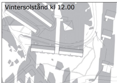
Figur 16: Solstudie för nya bostäders påverkan på befintliga bostäder. Fullständig solstudie finns i gestaltungsprogrammet. Illustration: Bergkrantz arkitektur
