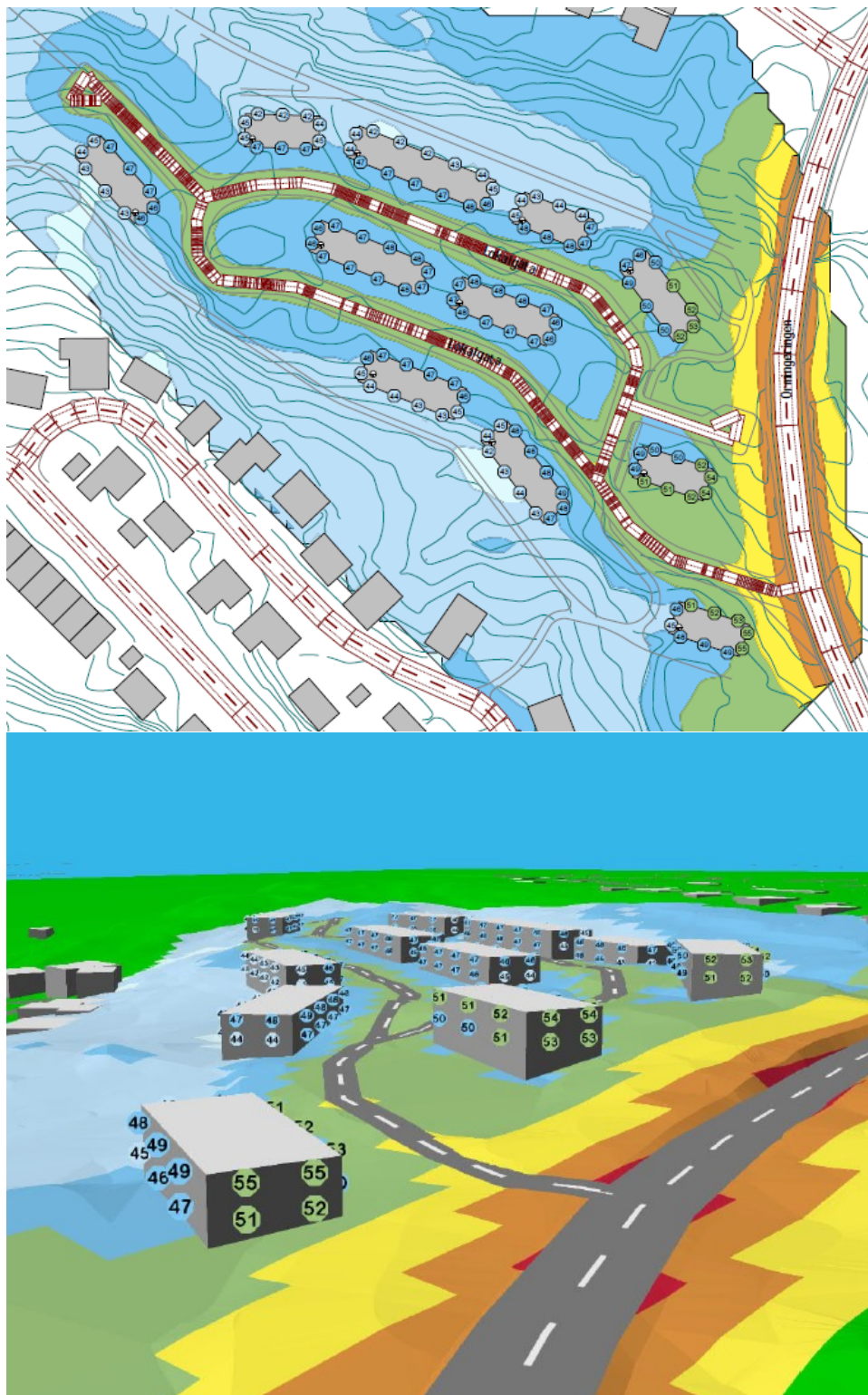
Figur 6. Ekvivalenta nivåer beräknade för år 2030 för detaljplaneförslaget Amperen. Bilden redovisar ett tidigare bebyggelseförslag men ljudnivåernas utbredning är desamma. Ekvivalenta ljudnivån vid planerade fasader mot Ormingeringen beräknas att uppgå till högst 55 dB(A) (Tyréns, 2019).
