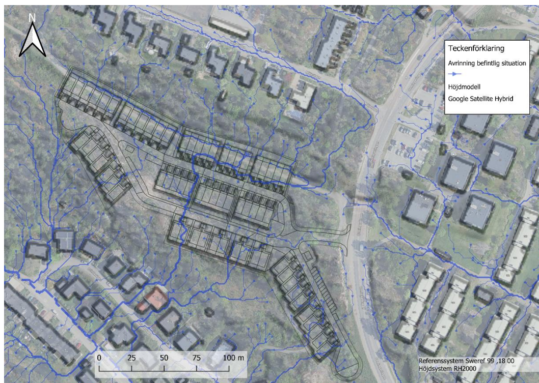
Figur 2. Ytliga flödesvägar, blå linjer, baserat på befintliga topografiska förhållanden visar att planområdet avvattnas i sydvästlig riktning. Bakgrundskarta utgörs av planerad exploatering illustrerad med svarta linjer och en höjdmodell med hillshade-illustration hämtad från Scalgo Live (2025).
