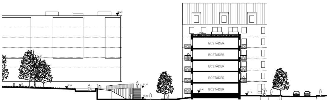
Sektion gård 2 – kvarter C där befintlig gård ommodelleras för att möta den nedre nivån. (bild: Mandaworks)
