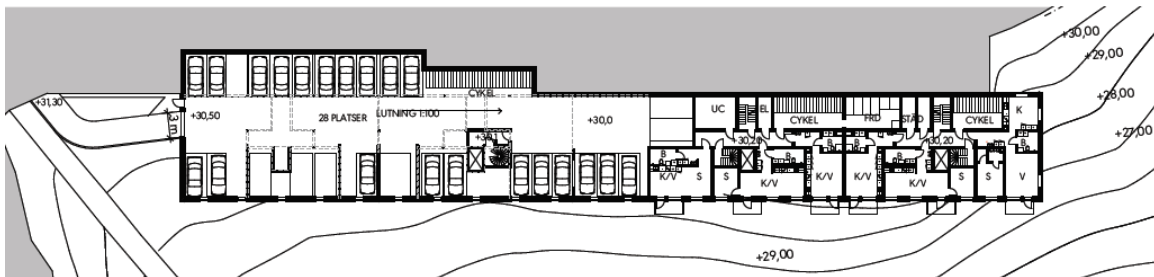
Figur 12: Parkeringsgarage/ souterrängvåning som innehåller 28 parkeringsplatser och bostäder. Parkeringsgaraget angörs via Ejdervägen. Illustration: Bergkrantz arkitektur
