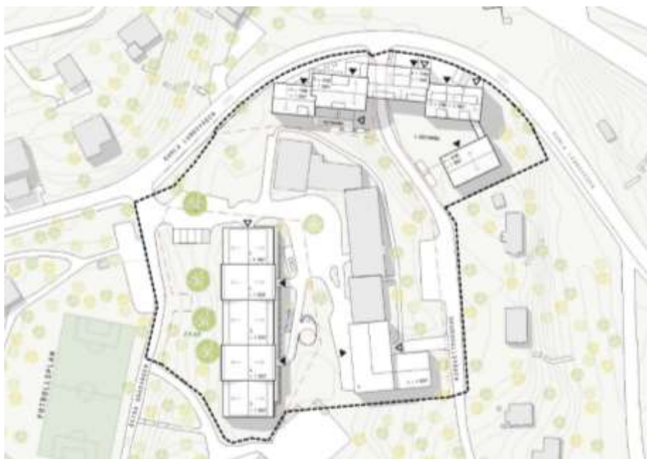
Situationsplan som visar på planförslagets huvuddrag. Planområdet är markerad med svartstreckad gräns. Befintliga byggnader är grå och föreslagna nya byggnader är vita.
