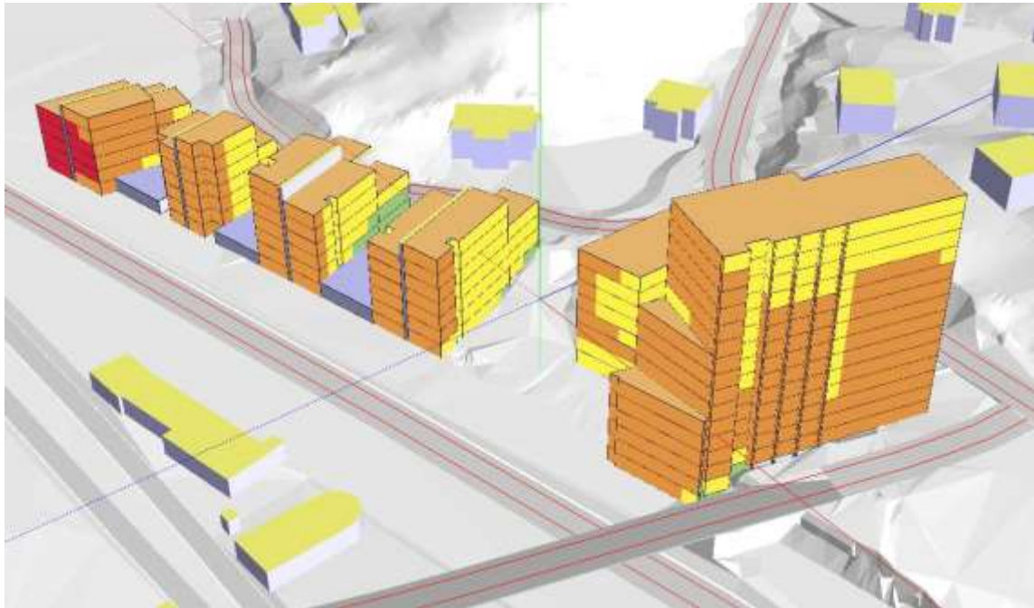
Bilden visar ekvivalenta ljudnivåer vid fasad. Bild: Efterklang, 2022
