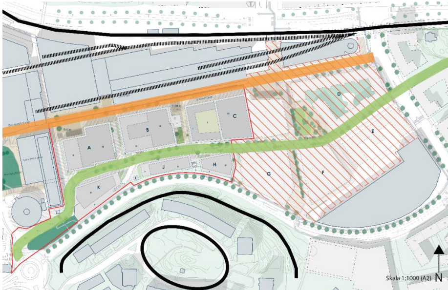
Figur 12. Principiell illustration av bebyggelseförslagets riktningar. Norra delen av planområdet respekterar de gamla stickspårens riktning (orange) och den nya Siroccogatan återspeglar landskapets och Järlaledens böljande riktning (grön). Planområdet markerat med röd figur. Bild: Gehl, 2023. Redigerad av kommunen.
