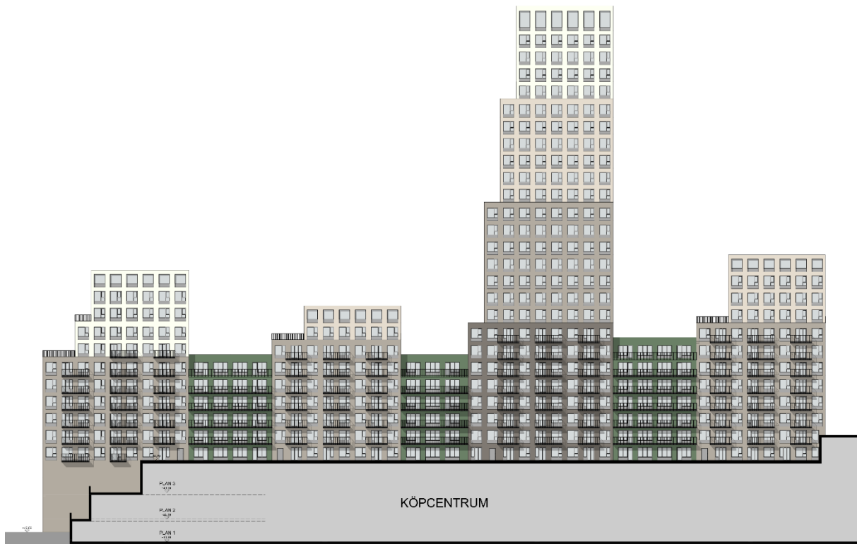
Figur 11. Fasadelevation sett från öster och vidhäftningen med befintliga Nacka Forum. Utifrån bilden förstås också bostädernas åtkomst till den upphöjda gården, placerad på Nacka Forums befintliga tak. Bilden visar möjlig utformning, slutlig utformning avgörs i bygglovet (Bild: Koncept part of AFRY)
