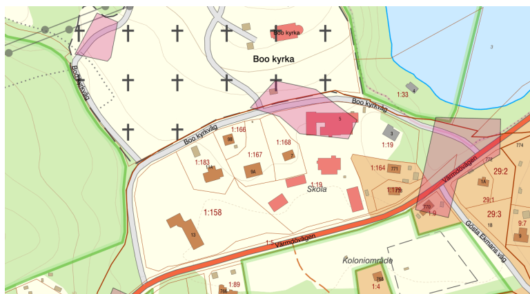
Figur 10: Förutsättningar för skred i finkornig jordart. Rosa område visar akksamhetsområde för skred i finkornig jordart. Bildkälla: SGUs Förutsättningar för skred i finkornig jordart
