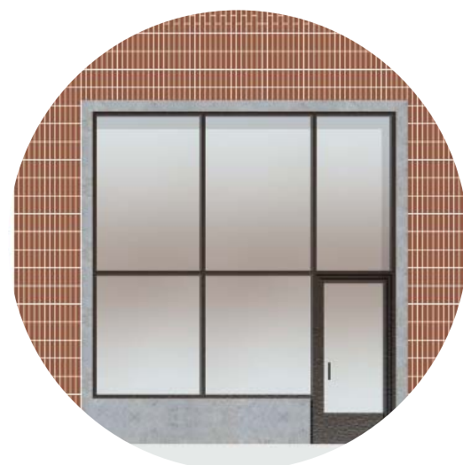
Ram av betong i klinkerfasad Övriga entréer och partier i sockelvåning
