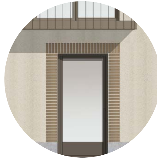
Ram av klinker i putsfasad Entré mot gård
