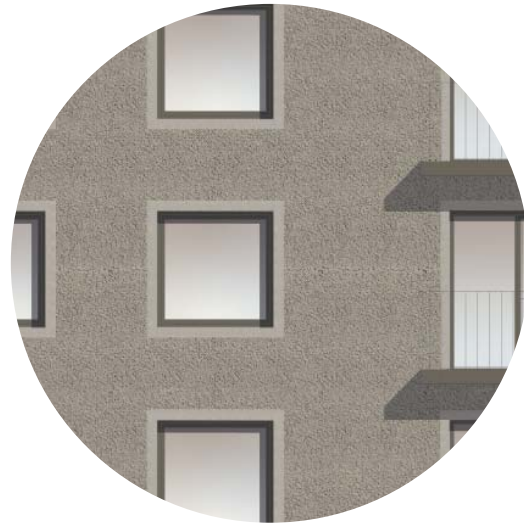
Ram av slät puts framhäver fönster i enheter som har mörk puts
