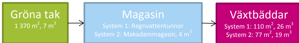
Figur 14 Översiktlig systemuppbyggnad med areabehov (m 2 ) och fördröjningskapacitet (m 3 ). Se även bilagan Avvattningsplan.
