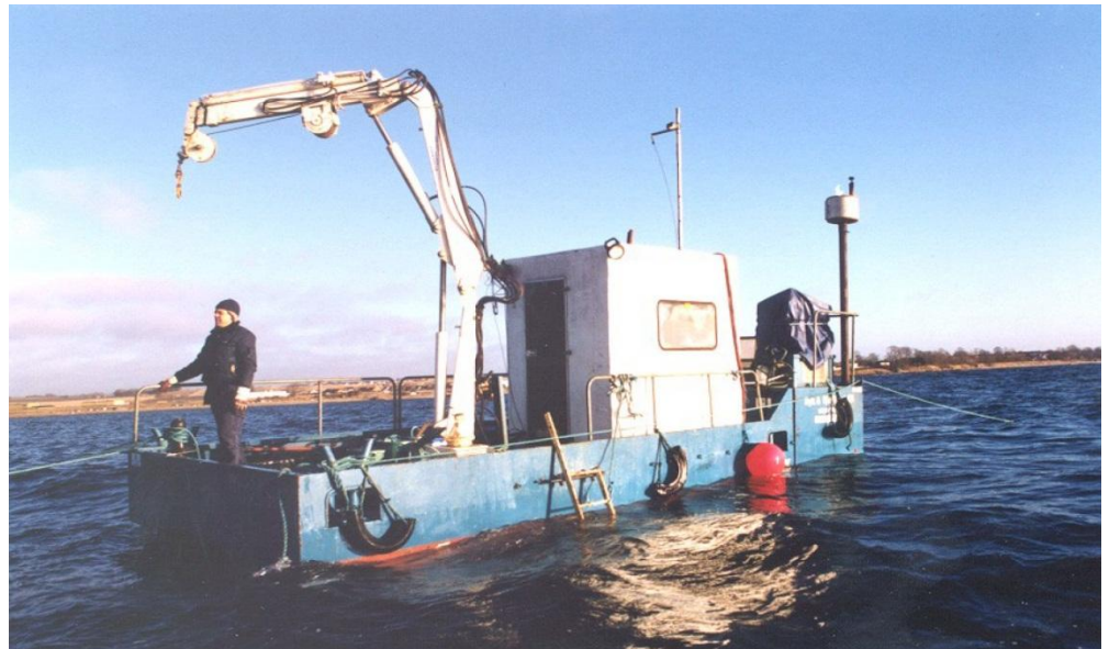
Figur 14, Arbetspråm för mindre lyft.
