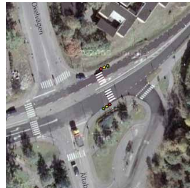
Figur 5.2 Möjlig utformning av trafiksignal för ett övergångsställe på Ältavägen
