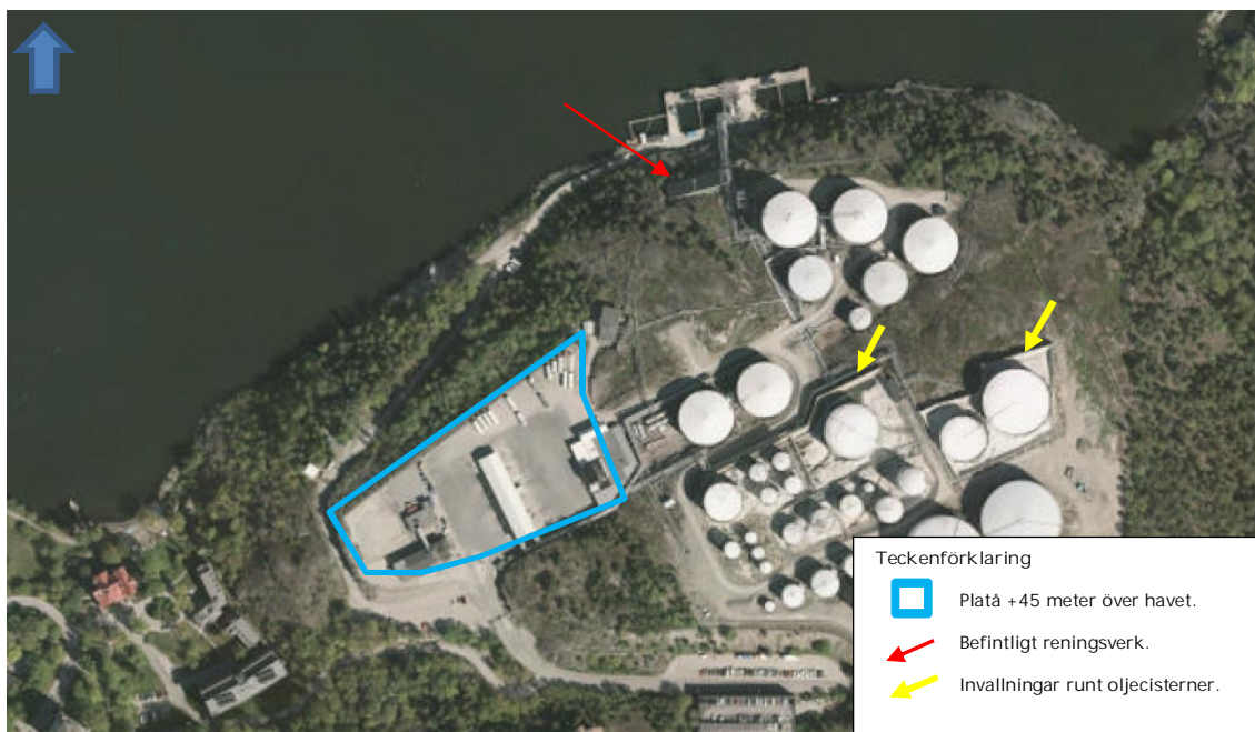
Figur 6. Befintliga dagvattensystem. (från förfrågningsunderlag).
