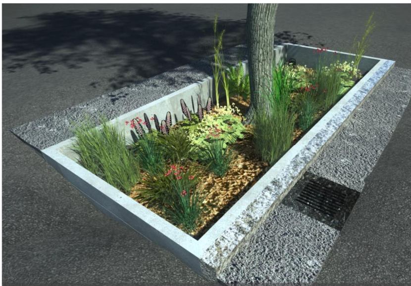
Figur 8. Exempel av öppen nedsänkt växtbädd 16
