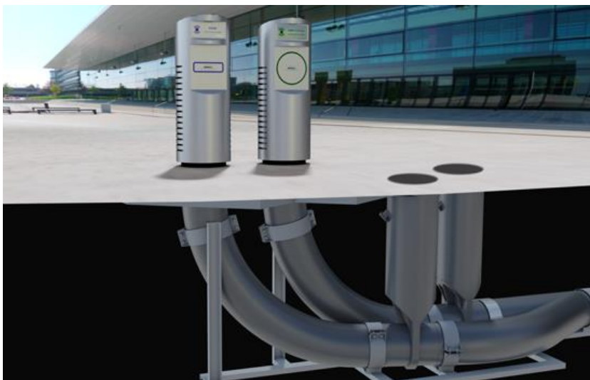
Figur 11, Inkast Logiwaste, kräver inte teknikutrymme undertill.
