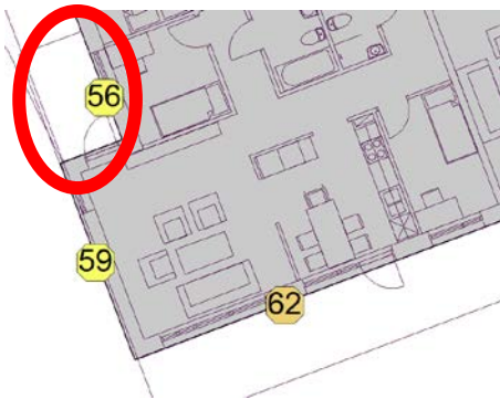
Figur 6 – Ekvivalenta nivåer för hus C. Röd markering visar var balkonger behöver förses med tätt räcke för att dämpa bullret mot fasad.
