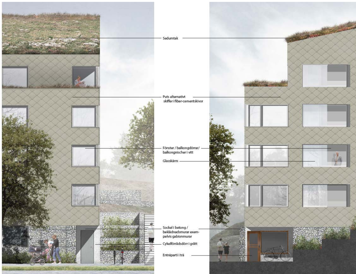
Exempel på fasadutformning. Till vänster fasad mot Talluddsvägen. Till höger fasad mot söder/gård. Illustration: Krook & Tjäder arkitekter.
