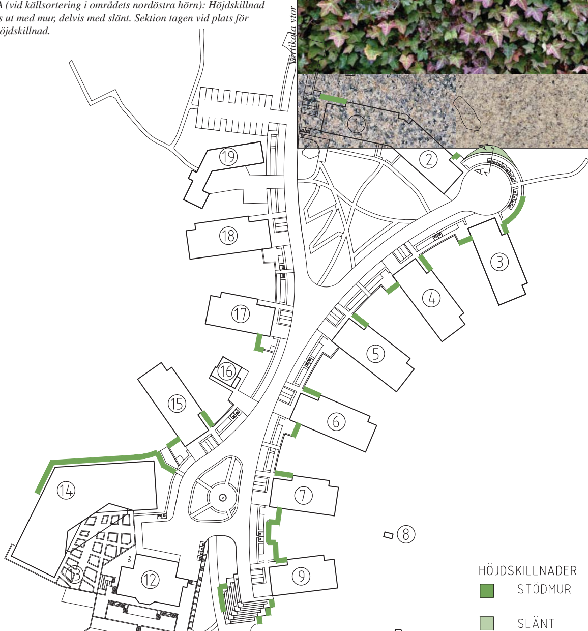
Skärningar med stödmurar och slänter.
