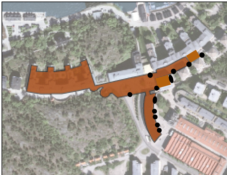
Torggaragets utbredning med befintliga schakt för brandgasventilation
