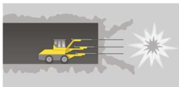
Salvborrhning, laddning och sprängning: 1-5 meter långa hål borras i tunnelfronten och laddas med sprängämne. Sprängningsarbetena anpassas med hänsyn till risker för skador till följd av vibrationer.
