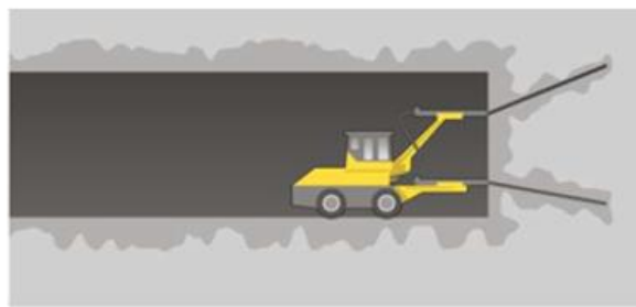
Förinjektering: Betong sprutas in i borrhålet och i bergsprickor. När betongen stelnat har det bildats en tät ring runt den blivande tunneln. Syftet med förinjektering är att minimera inläckage av vatten.
