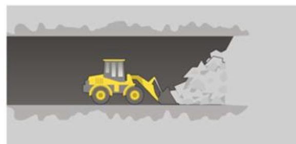
Bergrensning: Kvarsittande löst berg i väggar och tak knackas och bryts bort. Vid behov utförs bergförstärkning med sprutbetong och bultar. Bergytan spolas ren med vatten och de utsprängda massorna bevattnas för att reducera dammspridning. Slutligen lastas massorna ut och transporteras bort.
