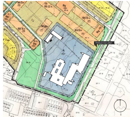
Diagram som visar detaljplanens konsekvenser för byggnadsvolymer. Takfot max 8 meter över medelmarknivå. Taklutningar under 45 grader.
