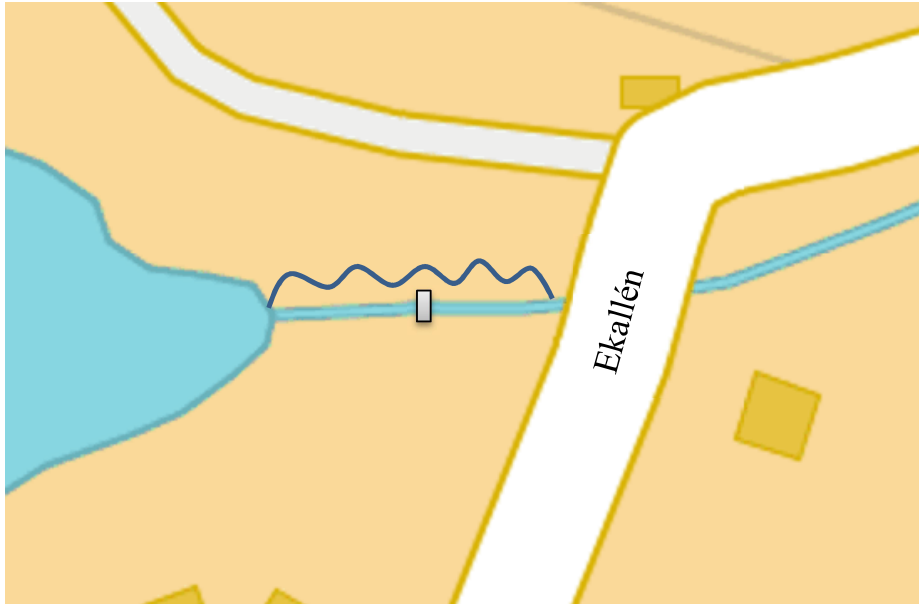
Figur 4-3 Förslag på placering av överfall samt förbipassage för bottenlevande organismer.
